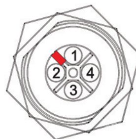
Fig. 6. Esquema de los pines de la batería principal del equipo. Los pines 1 y 4 son los que se deben usar para ver la carga de la batería con multímetro (tomada del manual oficial West System).
