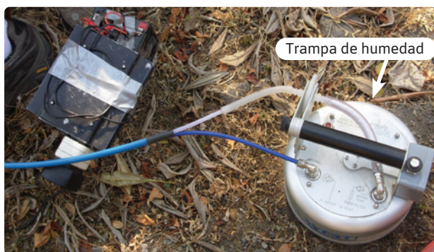
Fig. 9. Vista trampa de la humedad de la cámara de acumulación.
