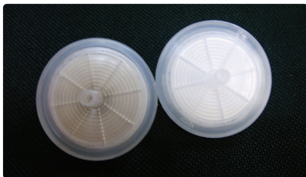
Fig. 7. Comparación entre dos filtros, uno usado y el otro nuevo.
