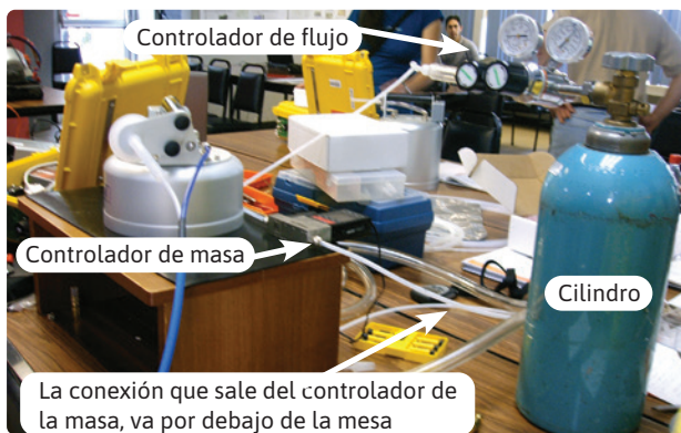
Fig. 34. Vista de las conexiones.
