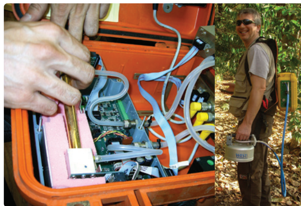
Figura 5. Vista de mangueras utilizadas en el equipo. Dentro del equipo, de silicón (arriba) y mangueras externas de teflón (abajo).
