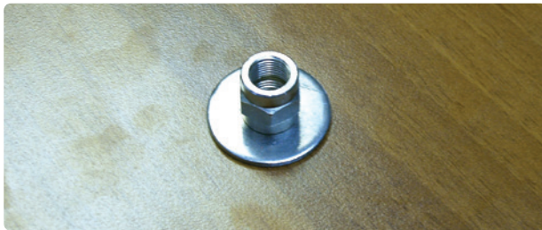
Fig. 28. Acercamiento de la conexión entre la bolsa y el suelo simulado.
