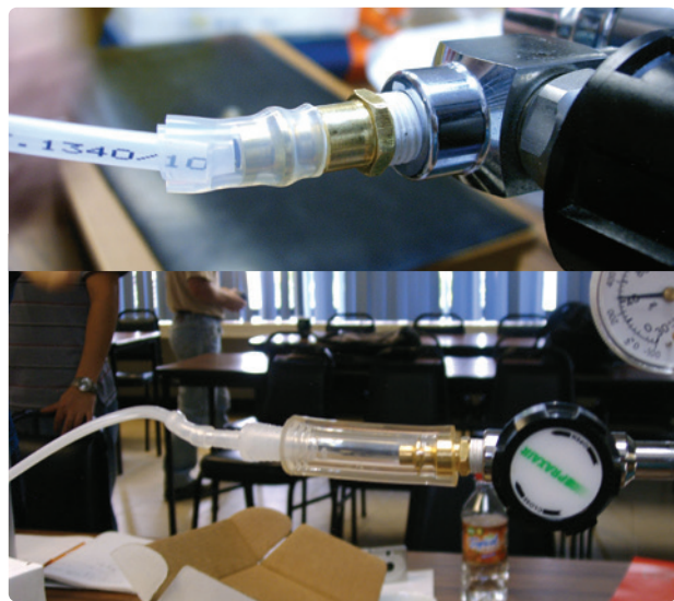
Fig. 33. Ejemplo de conexión fallida (arriba) y de conexión correcta (abajo).
